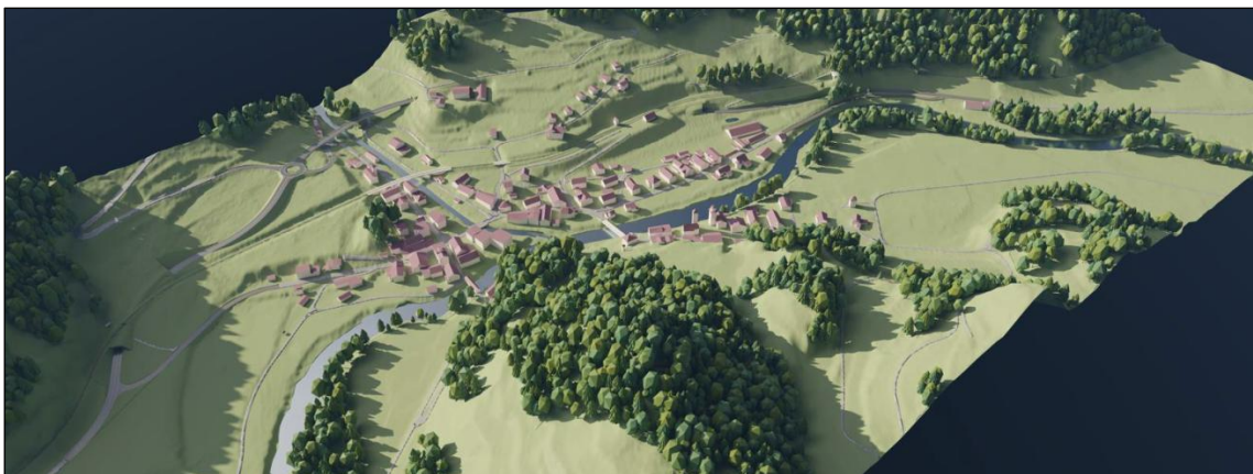
Abb. 10: Visualisierung Variante 30 (Umfahrungsstrasse tritt unterhalb des Bahnhofs aus dem Tunnel hervor und verläuft anschliessend oberirdisch weiter; Gärtnereizone wird randlich tangiert)
